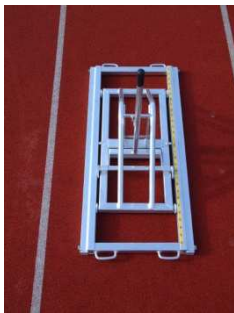
Laufschiene mit Gewichten, Griffe für Transport und innen liegendem Laufwagen
